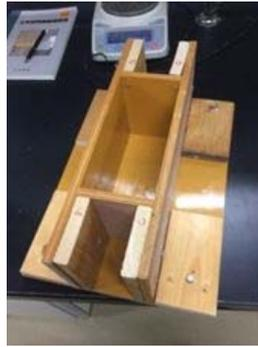
図-4 供試体作製に用いた型枠
