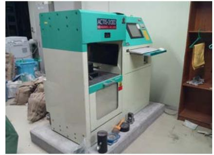
図-5 全自動圧縮試験機
