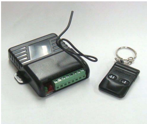
図4. リモコン送受信機 (右: 送信機, 左: 受信機)
