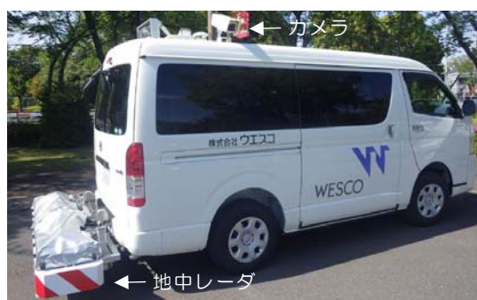
路面下空洞探査車
